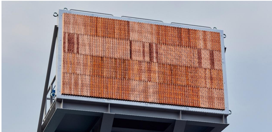
Protótipo de sistema de antenas com guia de ondas ranhurado fabricado com resina moldada por injeção
