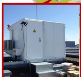
Lidar Doppler de aeroporto Para detetar vento lateral em condições sem precipitação
