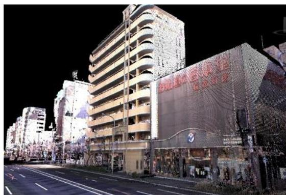
Exemplo 4: Medições detalhadas do aspeto de edifícios com o scanner a laser de alta densidade ou de longo alcance opcional
