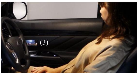
Existem três tipos (1, 2 e 3) de iluminações animadas que mudam quando os sensores detetam peões nas proximidades
