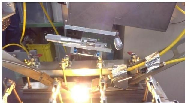
Fig. 1. Comparação visual dos salpicos durante a soldadura por laser de fibra
