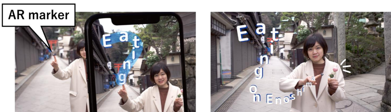
Posicionamento do texto ao utilizar um marcador de RA (lado esquerdo: antes; lado direito: depois)
