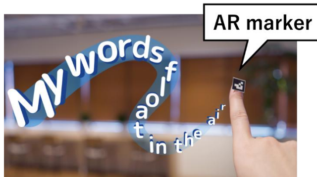
Apresentação de texto ao acompanhar um marcador de RA na imagem da câmara
